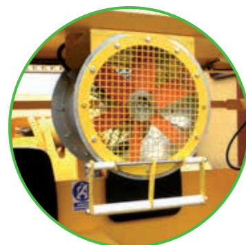
Wentylator nawiewowy z niezależnym zasilaniem
