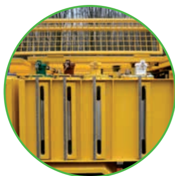
Wzierniki umożliwiają odczyt poziomu napełnienia zbiorników
