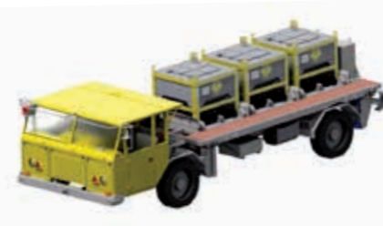
Transport do 3000kg matrycy emulsji w specjalnych zbiornikach
