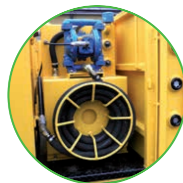
Zbiornik na zużyty olej z zabudowaną pompą odsysającą
