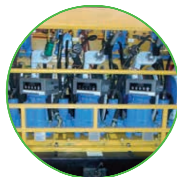
Agregat wydawczy zasilany pneumatycznie
