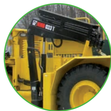
Żuraw HIAB 033T-3 udźwig 3,3tm, zasięg 4,8m
