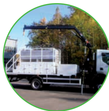
Żuraw umożliwiający samodzielny załadunek pojazdu
