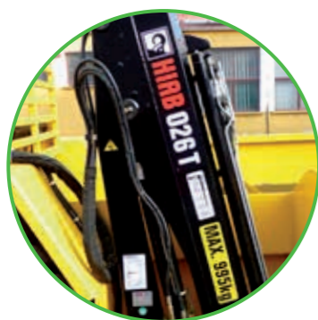
Żuraw Hiab 026T-3 udźwig 2,6Tm, zasięg 4,6m
